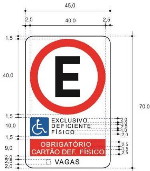
Figura 8 – sinalização vertical para vagas reservadas para P.C.D.
