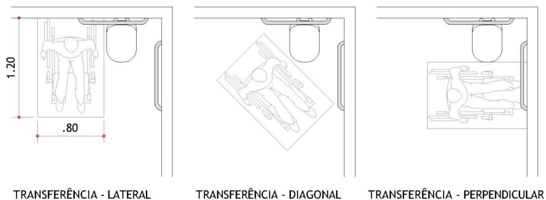
Figura 48 – formas de transferência para bacia sanitária de P.C.R.
